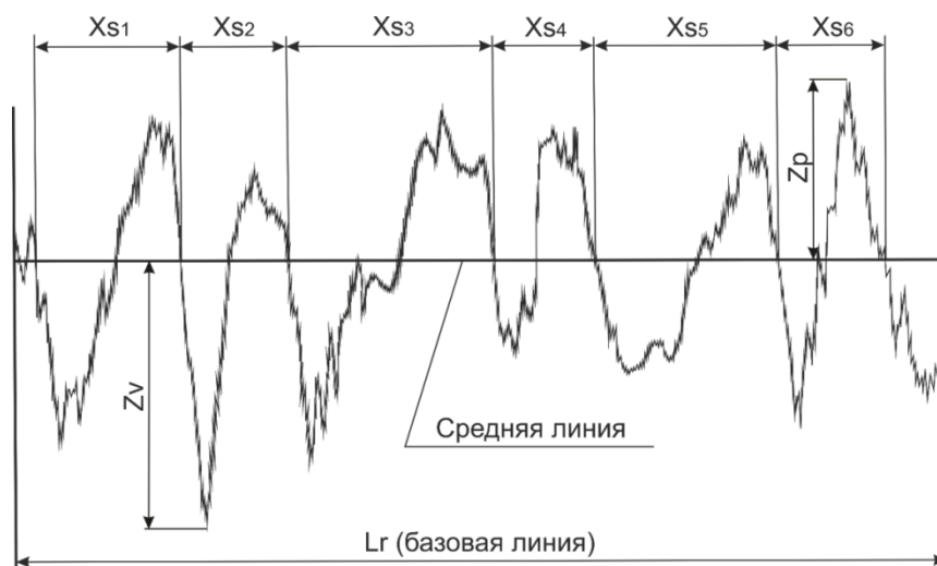
Рис. 1.1. Основные параметры поверхности профиля
