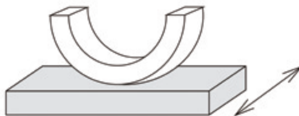
Рис. 3.4. Схема испытания образцов по схеме «втулка цилиндра – поршневое кольцо»
